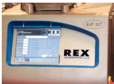
Der voll integrierte Rex-Touchscreen wird bei allen Maschinentypen eingesetzt und bietet dem Anwender einfachste Bedien- und Einstellmöglichkeiten
