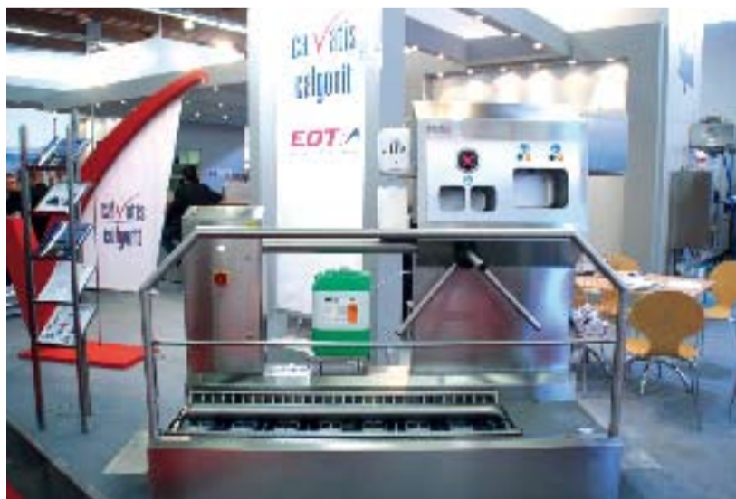
In Zusammenarbeit mit EDT wurde diese Hygieneschleuse mit Zutrittskontrollmöglichkeit realisiert
